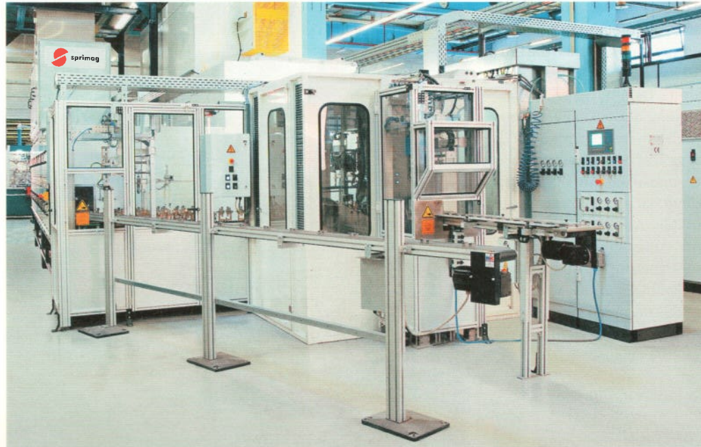
Blick auf die neue Lackierlinie, in der Harting Electric Steckergehäuse verschiedener Größen pulvert.
